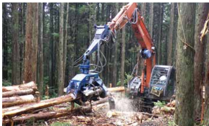
高性能林業機械(プロセッサ)による造材作業
